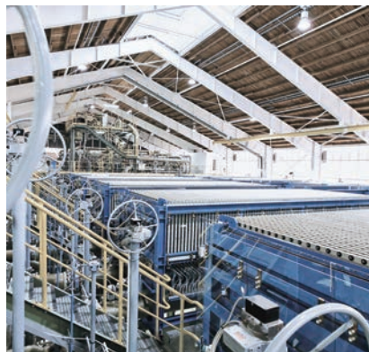
BM シングルエレメント型電解槽 Single element type electrolyzer
