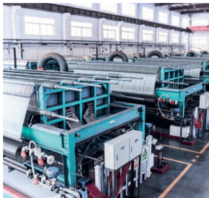
BiTAC® フィルタープレス型電解槽 Filter press type electrolyzer
